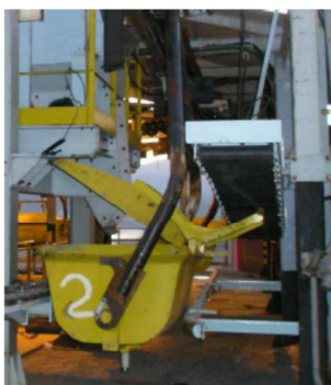
Figure 21 : système de transport de bennes (véhicules) par câbles proposée par POMA (Source : POMA)
