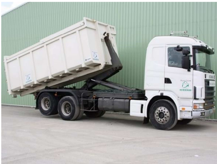
Figure 15 : Exemple de camion polybenne de PTAC 26 T
