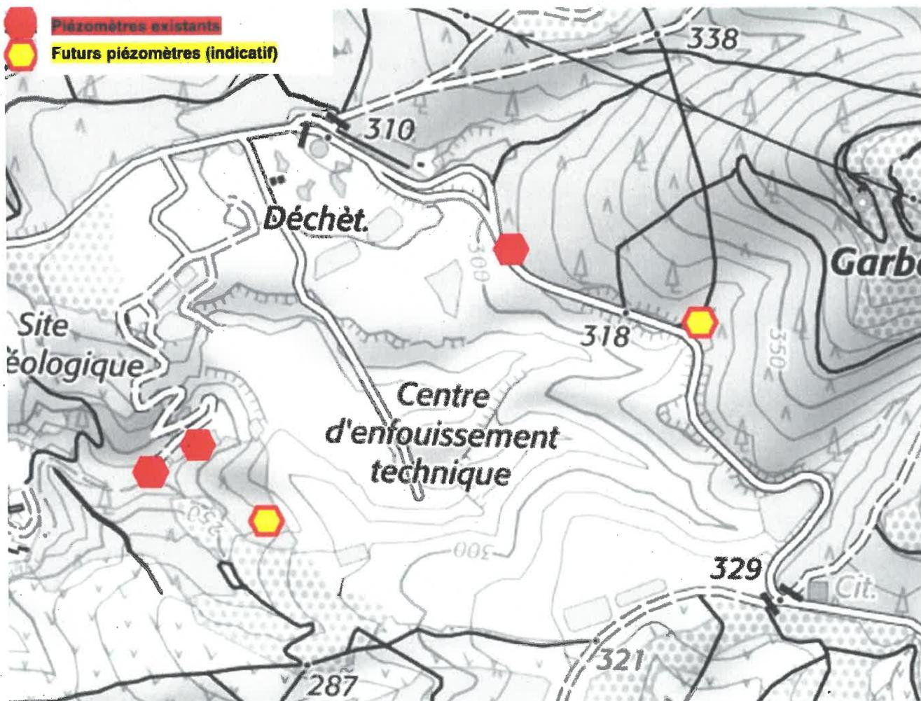
FIGURE 112 : PROPOSITION INDICATIVE D'IMPLANTATION DES DEUX FUTURS **PIEZOMETRES**
